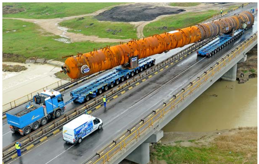
Utilizarea meselor rotative a permis traversarea decalată a podului.
