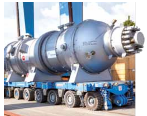
A mai fost imbarcat și un „High Pressure Heat Exchanger” de 150 tone.
