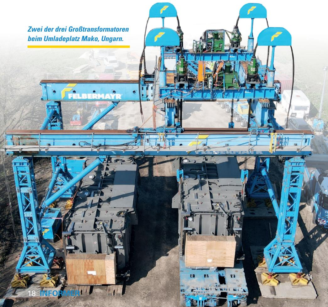
Einer der beiden wurde bereits zuvor auf einen 12-achsigen 3-file SPMT verladen und gesichert. Die Fahrt führte zuerst auf der Donau, dann via Theiß nach Tape in Ungarn. Über eine sogenannte RoRo-Rampe (aus dem englischen Roll-on, Roll-off) rollte der SPMT mit dem ersten Generator aus dem Schiff aus und fuhr direkt weiter durch die Stadt Mako. Auf einem Umladeplatz wurde der Generator mittels Tower-Lift und Litzenheber-System vom SPMT auf ein weiteres Transportfahrzeug gehoben.
