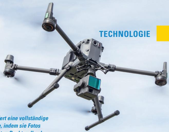
*Die Laserscanner-Drohne liefert eine vollständige fotorealistische 3D-Aufnahme, indem sie Fotos erstellt und aufgrund der dichten Punktwolke das Gelände in der richtigen Farbe einfärbt.*
